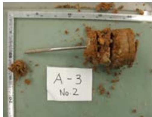
A-3 地点で採取した試料 2 の状態。砂、礫分が多く不攪乱状態での採取が困難であった。
