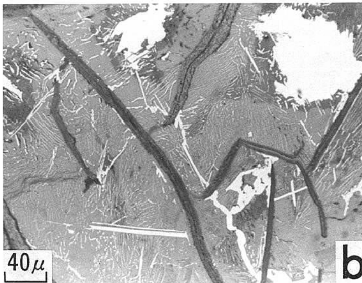
b) 鑄鉄大塊の表面黒錆の顕微鏡組織 黒色ひも状物質は黒鉛。明色の島状と片状の結晶は初析セメントライト。灰色地の中の細脈状物質はもとのパーライト相中セメントライト。鑄鉄塊は愛知, 高山古墳出土。
