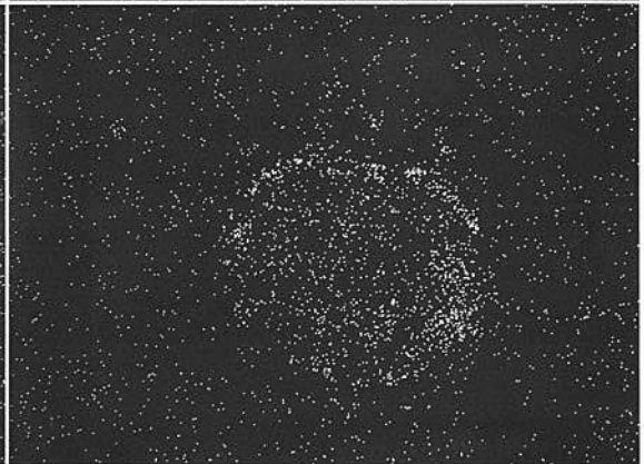
小鉄塊(O-831)の非金属介在物の走査X線像(金属鉄) ×500
