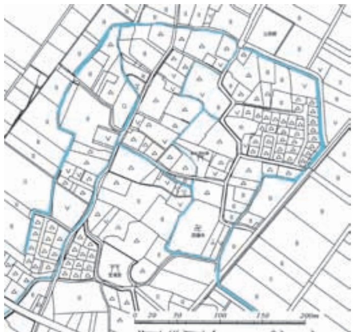
第45図 中牟田城地割図 (現在の地籍図を基に事務局作成) ※青線は水路、△は宅地を示す。
